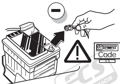
**DE** Um Störungen und Schäden am Bordnetz zu vermeiden, muss die Massepolklemme unbedingt vor Beginn aller Arbeiten von der Fahrzeugbatterie getrennt werden! Insbesondere bei Arbeiten und Anschlüssen am CAN-Datenbus kann bei nicht abgeklemmter Batterie sowohl das Anhängermodul als auch das fahrerseitige Bordnetzsteuergerät beschädigt werden! Bitte Herstellervorschriften beim Ab- und Anklebmen der Fahrzeugbatterie beachten!
