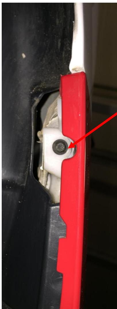
Entfernen Sie diese 15er Torx Schraube an der Innenseite des Kotflügels auf beiden Seiten
