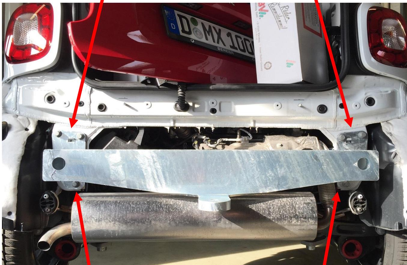
An diesen Stellen wird der Kupplungsträger mit den beiden neuen, mitgelieferten Schrauben/Unterlegscheiben M10 X 45 mit 80NM festgeschraubt.
