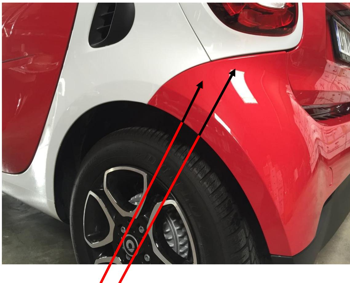
Auf beiden Seiten des Kotflügels an diesen Stellen ziehen und so den Kotflügel ausrasten.
