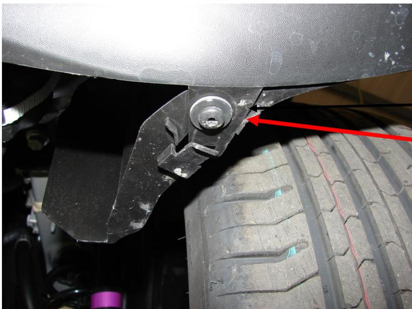
Entfernen Sie diese 15er Torx Schraube an der Unterseite des Heckteils auf beiden Seiten
