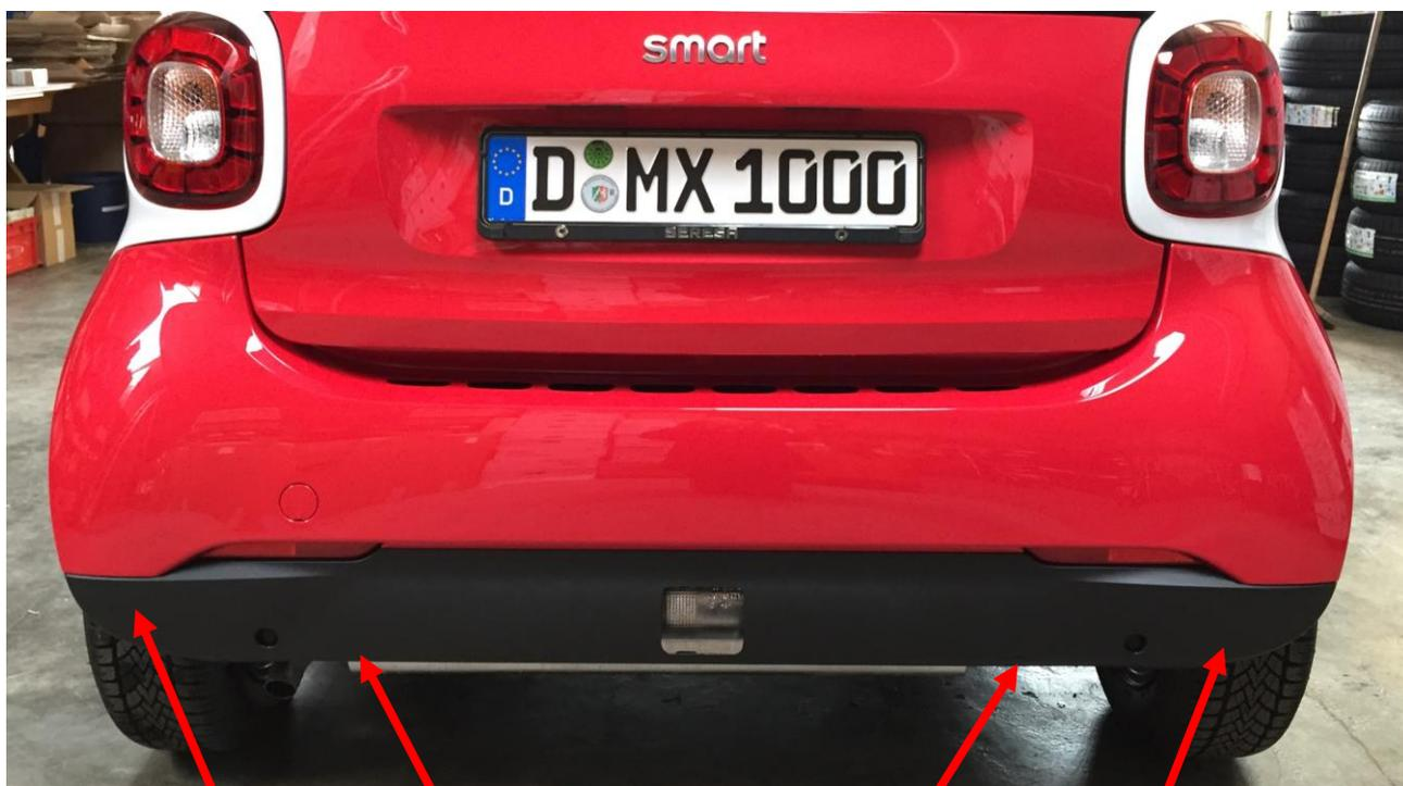
Entfernen Sie diese vier 15er Torx-Schrauben. Die äußeren Schrauben befinden sich an der Unterseite wie auch im folgenden Bild zu sehen
