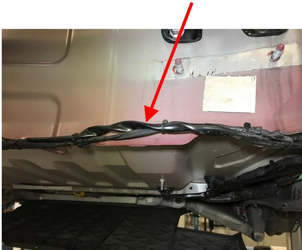
Anbauanweisung E-Satz für Anhängerkupplung Tesla Model S
