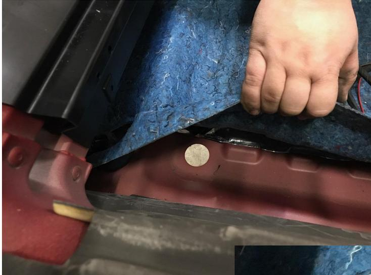
Ziehen Sie diesen Gummistopfen heraus und versehen ihn mit einem Kreuzschnitt in der Mitte. Führen Sie das Ende des Kabelsatzes durch den Stopfen und führen das Kabelende bis zum Elektrodosenhalter.
